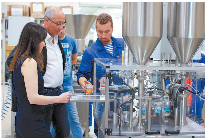
Испытание работы фасовочного автомата на таре заказчика
