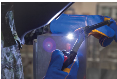
Процесс сварки аргонной установкой
