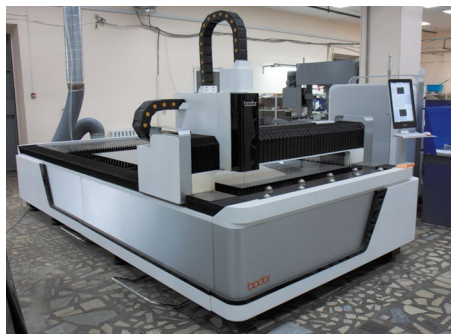
Раскрой листового металла с помощью лазерной установки
